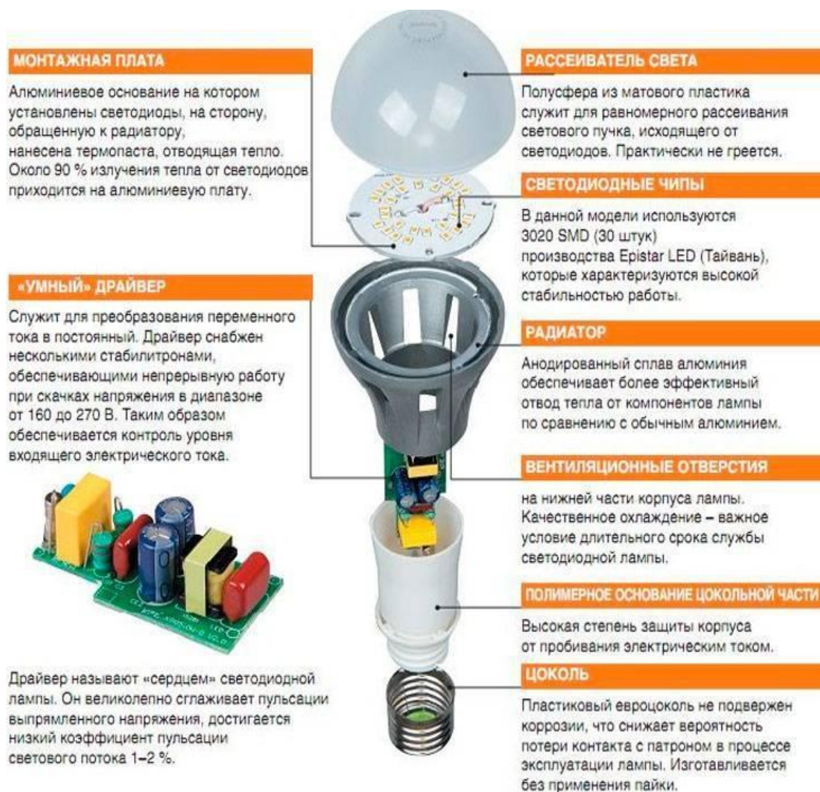
Рисунок 1. Устройство светодиодной лампы
